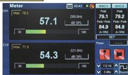
音圧、dBu、dBV、電圧レベルを高精度メーターで測定できます。音圧レベル測定は30~130 dB SPL、dBu測定は-85~25dBu、dBV測定は-87.2~22.8dBV、電圧測定は0.0436mV~13.8V。
