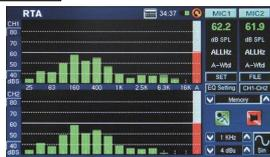
1、2/3、1/3、1/6Oct精度、A/B/C/Flatウェイト、設定応答時間でリアルタイム測定ができます。
