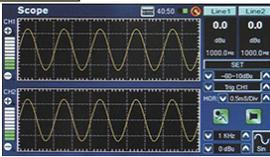
このオシロスコープで信号の波形を表示します。時間、レベル精度はユーザー設定でき、表示波形の拡大/縮小ができます。
