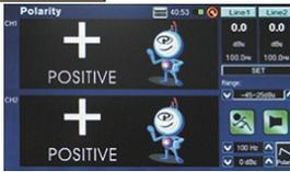
この機能でスピーカの極性チェックができます。極性測定信号はPAA6から出せます。またPAA6は標準極性信号を使用して測定もできます。
