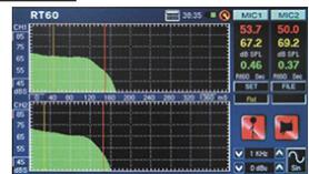
部屋の残響時間の測定と時間/レベルによる標準残響カーブを表示します。特定の周波数にフィルターした結果表示ができます。
