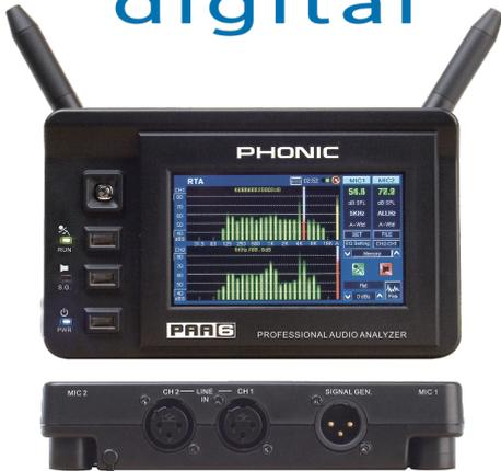
PAA6は先進のハンドヘルド 2チャンネル オーディオアナライザーです。全機能とメニューは480 x 272カラータッチ スクリーンから素早く簡単に呼び出せます。PAA6はリアルタイム スペクトラム(RTA)、RT60、トーンジェネレーター、LEQ、EQ設定、フェイズチェックなどの基本機能の他、SLM、FFT、THD+N、スコープ機能を有し、正確な測定ができる2本のマイクを内蔵しています。PCからまたはPCへのデータ転送に便利なUSBコネクタ及びSDカードスロットを備えています。スナップショット機能で瞬時に画面表示結果が保存できます。高性能/多機能を備えたPAA6ポータブルアナライザーはプロオーディオエンジニア、製品開発者などに価値ある ツールです。ANSI S1.4 Type2, IEC61672 Type2 144.95x82.95x39.42mm / 54g
