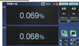
テストトーンを被測定オーディオ機器へ送り、そのユニットの全高調波歪ノイズ結果をPAA6で読取ることができます。
